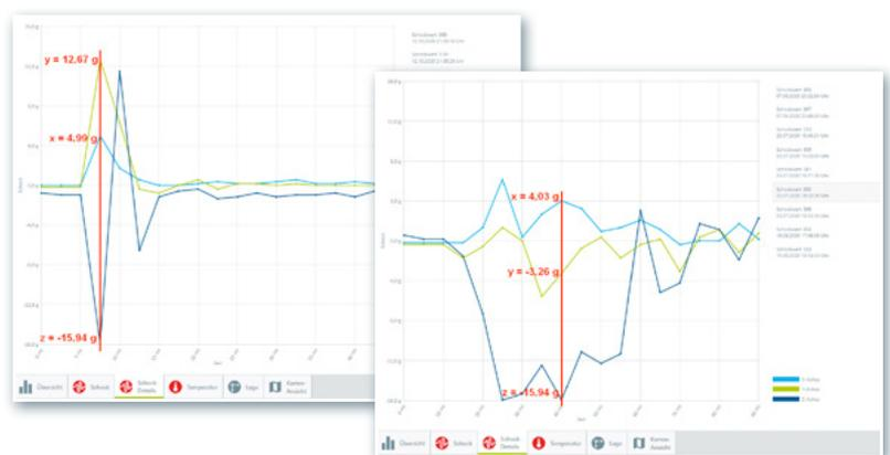
Der Verlauf eines Schocks ist in Millisekunden und pro Achse nachvollziehbar. Wie hier gut zu erkennen, ist nicht nur die Höhe der Beschleunigung je Achse relevant, sondern insbesondere die Dauer, die der Schock anhält. Damit lassen sich ernsthaft Beschädigungen erkennen.
