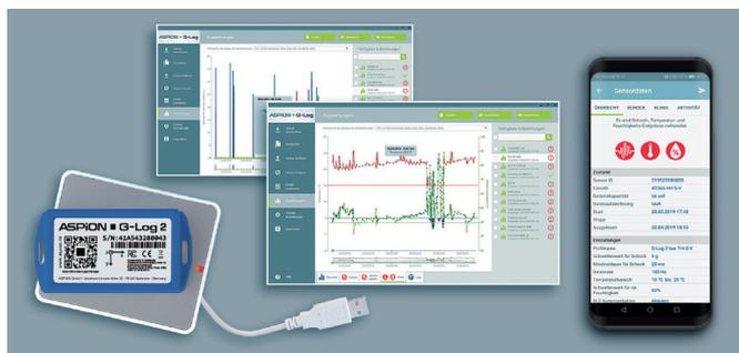
*G-Log 2 liefert belastbare Daten über Belastungen mit Schock/ Stoß, Temperatur und Feuchte während des Transports und sorgt so für Transparenz*
