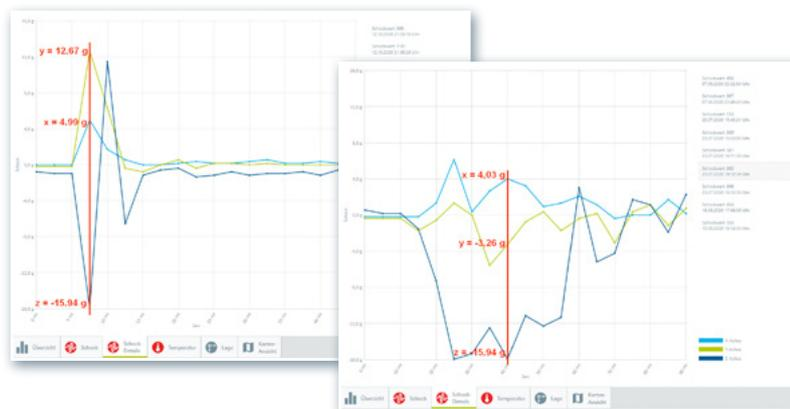
Der Verlauf eines Schocks ist in Millisekunden und pro Achse nachvollziehbar. Wie hier gut zu erkennen, ist nicht nur die Höhe der Beschleunigung je Achse relevant, sondern insbesondere die Dauer, die der Schock anhält. Damit lassen sich ernsthafte Beschädigungen erkennen.
